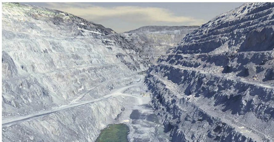
Рис. 2. 3D-модель місцевості, побудована на основі даних з БПЛА Raybird-3
